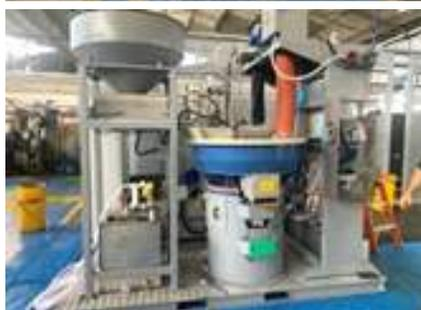
Renovamos los equipos del taller vainilla mediante la instalación de una Máquina de Cargue y Empaque de Cartuchos de Escopeta y Maquinaria para Mantenimiento Línea de Munición. Los resultados de esta mejora son:
