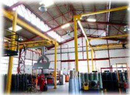
Implementamos equipos para manipulación de cargas para el taller de fabricación de cuerpos para bombas propósito fragmentación, con esta mejora logramos:
