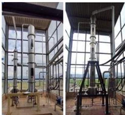
Implementamos una torre de absorción para gases nitrosos generados por el proceso de nitración. Reubicamos la torre de absorción actual al proceso de la unidad 200. Con esta mejora logramos:
