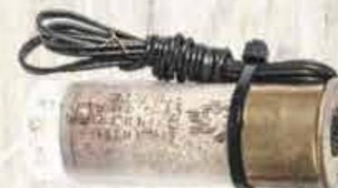
Cartucho disruptor de proyectil de corcho impulsor de agua que actúa como un émbolo sobre una carga de agua contenida en el cañón. Los valores de presión y velocidad dependen del volumen de agua contenido.
