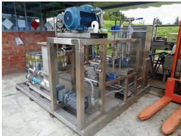
Módulo móvil para producción de emulsiones explosivas
