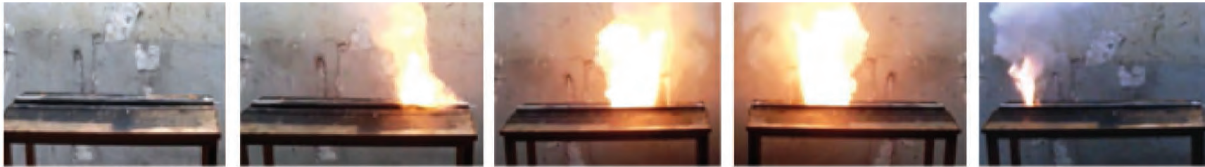
Ensayos balísticos de mecha de seguridad con carga deflagrante basada en cascarilla de palmiste
