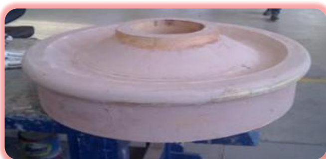
Figura No. 1- 19. Modelo en madera cedro amargo, Rueda de Ferrocarril CE-28 CI Prodeco
