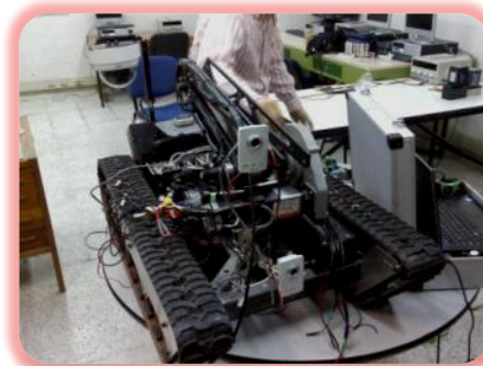
Figura No. 2- 79. Prototipo de vehículo móvil para el transporte y control del cañón disruptor.
