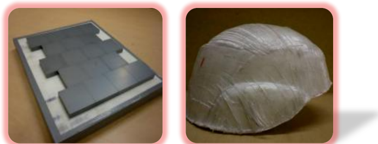
Figura No. 2- 77. De izquierda a derecha: Placas para protección balística y casco con refuerzo en material compuesto
