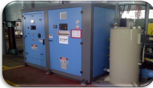
Figura N. 2 - 39 Horno de Inducción
