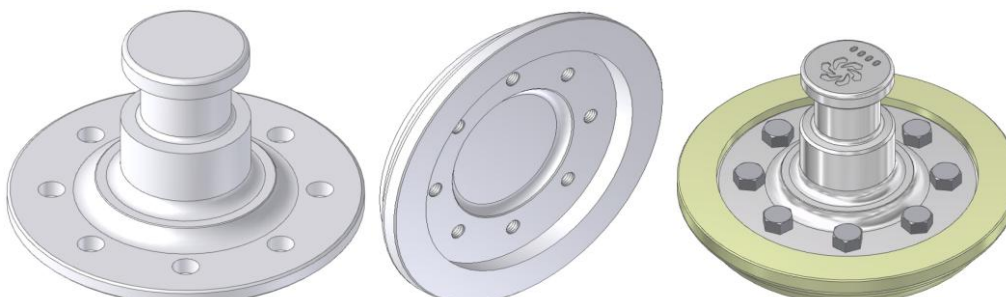
Figura N. 1 - 24 Repuestos para Carrocerías. Perno y Plato King Pin.
