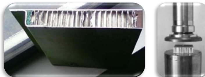
Figura N. 2 - 63 Placa para piso en material compuesto.
