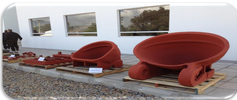
Figura N. 1 - 22 Cucharas para Draga – Acero al Manganeso
